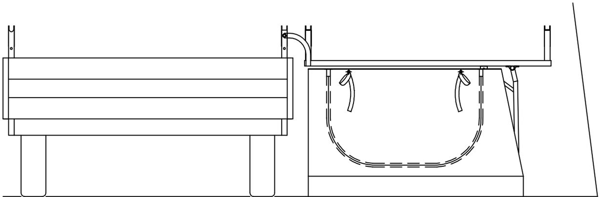
Montage: contre-percer 6 trous  $\varnothing 2,5$  et fixer les pressions
